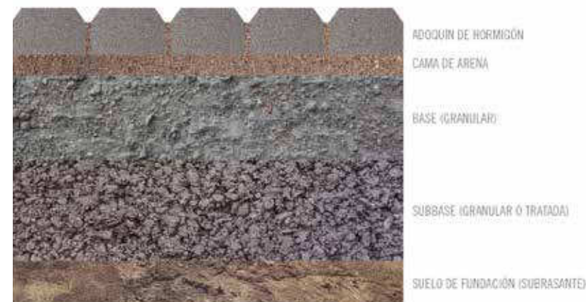
FIG.1. CAPAS DE UN PAVIMENTO DE ADOQUÍN DE HORMIGÓN
