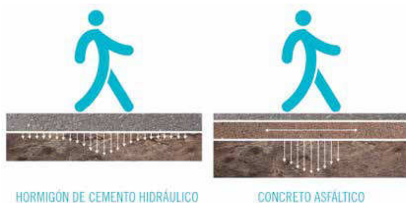
FIG.2. TRANSFERENCIAS DE CARGAS EN DOS TIPOS DE PAVIMENTOS
