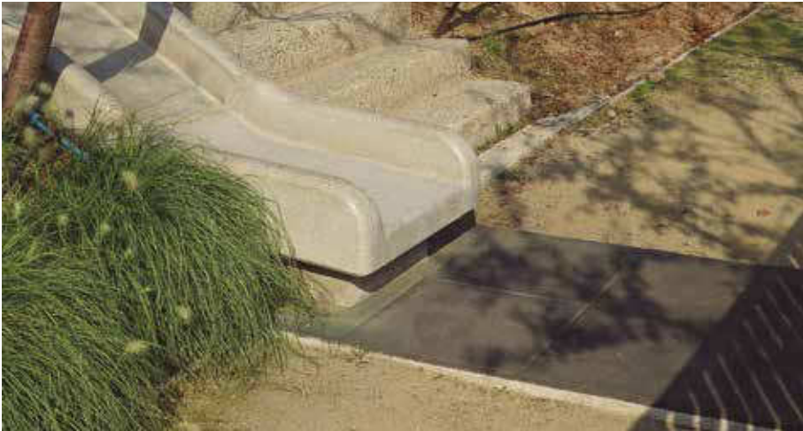
LOSETAS DE CAUCHO EN LA LLEGADA DEL RESBALÍN. PARQUE DE BICENTENARIO DE LA INFANCIA, RECOLETA, SANTIAGO Fuente: CDT
