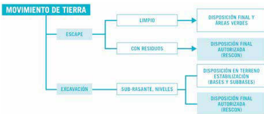
FIG.3. PRINCIPALES ACTIVIDADES DEL MOVIMIENTO DE TIERRA
