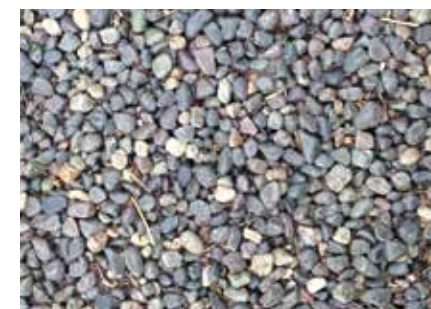
ALCORQUE DE PIEDRAS DRENANTES Y RESINA, LAS CONDES, SANTIAGO
