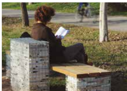
RELAJA - BANCO CON RESIDUOS DE MÁRMOL Y GRANITO
