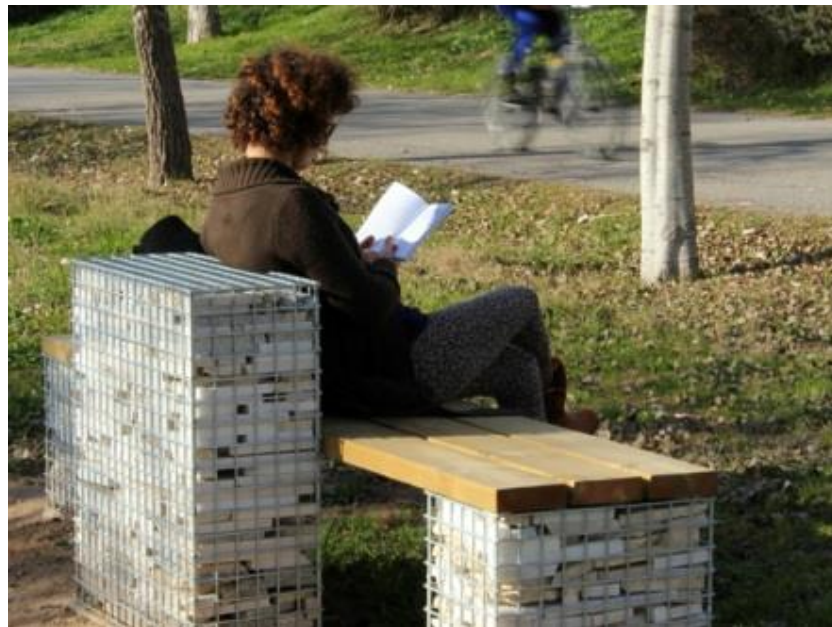
Asiento construido en módulos de acero galvanizado rellenos con restos de materiales de construcción de empresas locales. Fuente: Nutcreatives.
