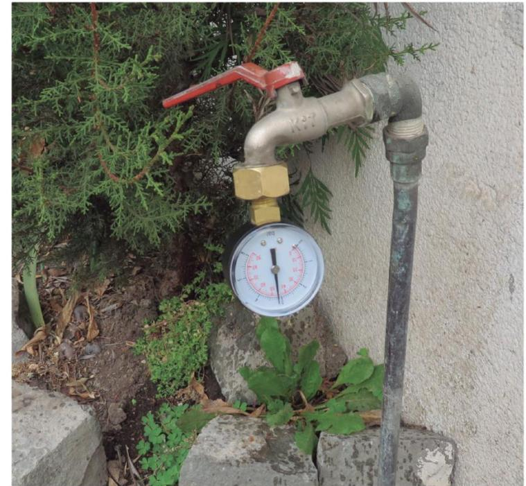
**MEDICIÓN DE PRESIÓN CON MANÓMETRO**
