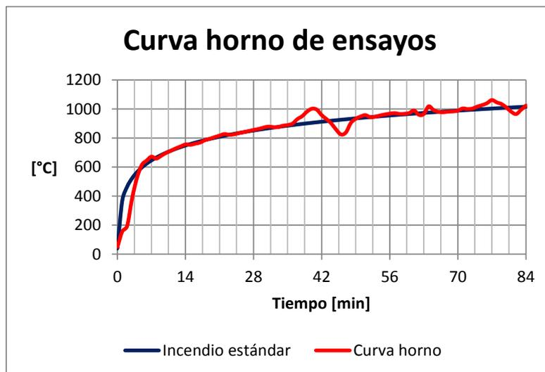
Figura 6.1 Temperatura promedio horno de ensayo
