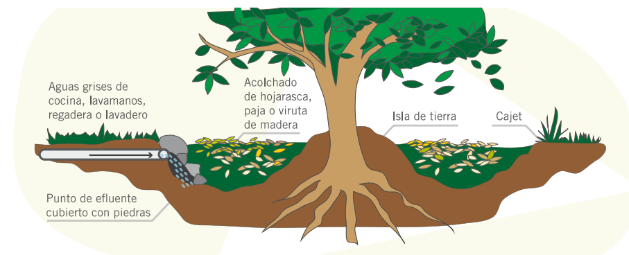
FIGURA 21. SISTEMA FILTRO DE ACOLCHADO.
